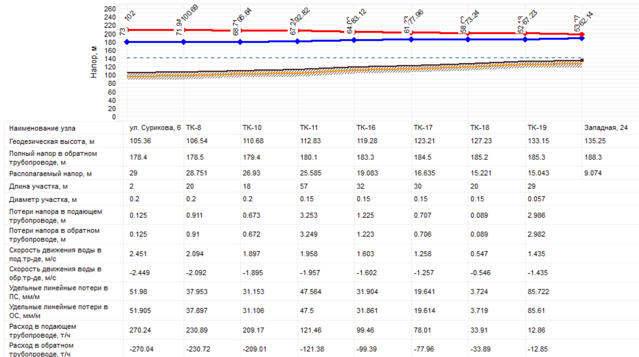
Рисунок – Пьезометрический график от котельной г. Алушка, ул. Сурикова, 6 (ГУП РК «Крымтеплокоммунэнерго»)
