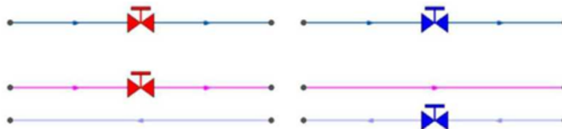
Рисунок 28 - Однолинейное изображение (вверху) и внутреннее представление (внизу) сети с регуляторами давления.
