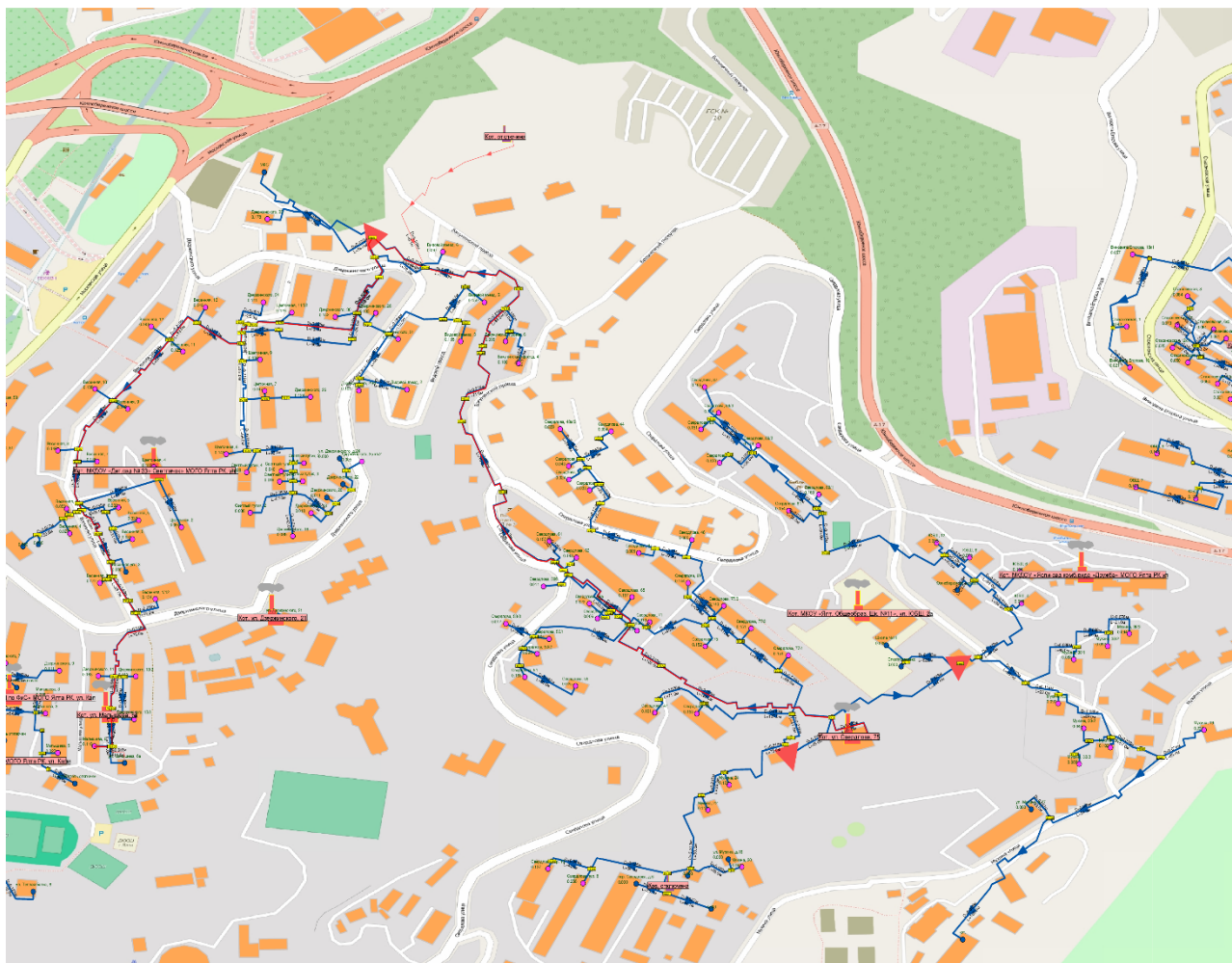
Рисунок – Схема тепловых сетей котельной ул. Свердлова, 75
