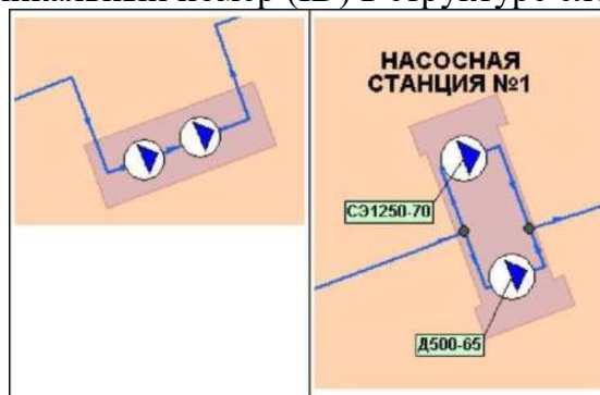
Рисунок 20 - Насосы, работающие последовательно (слева) и параллельно, разных марок (справа).
