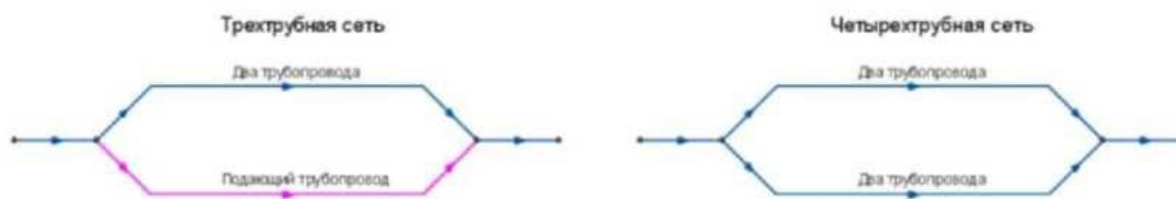
Рисунок 9 - Изображение трехтрубной и четырехтрубной сети.
