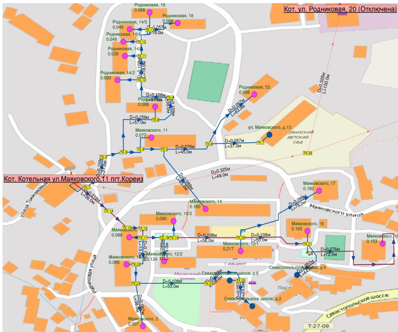
Рисунок – Схема тепловых сетей котельной ул. Маяковского, 11 пгт. Корейз
