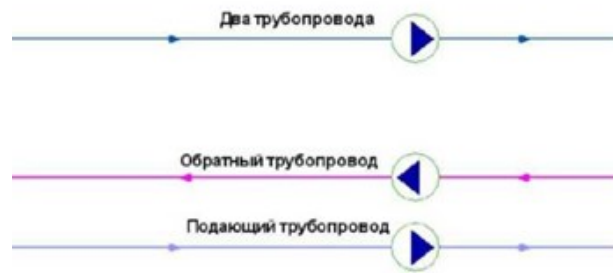
Рисунок 19 - Однолинейное изображение (вверху) и внутреннее представление (внизу) сети с насосными станциями.
