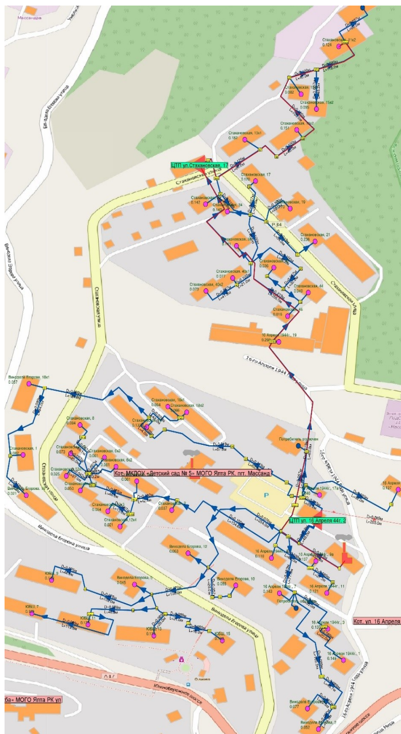
Рисунок – Схема тепловых сетей котельной ул. 16 апреля 1944 г., 2
