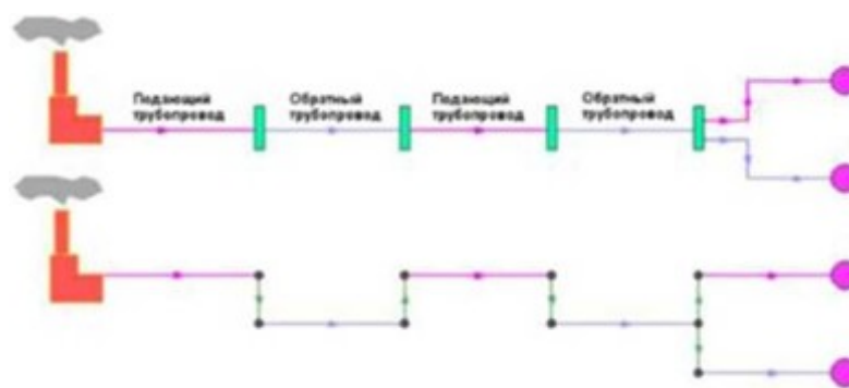
Рисунок 25 - Однолинейное изображение (вверху) и внутреннее представление (внизу) сети для летнего режима работы открытых систем централизованного теплоснабжения.
