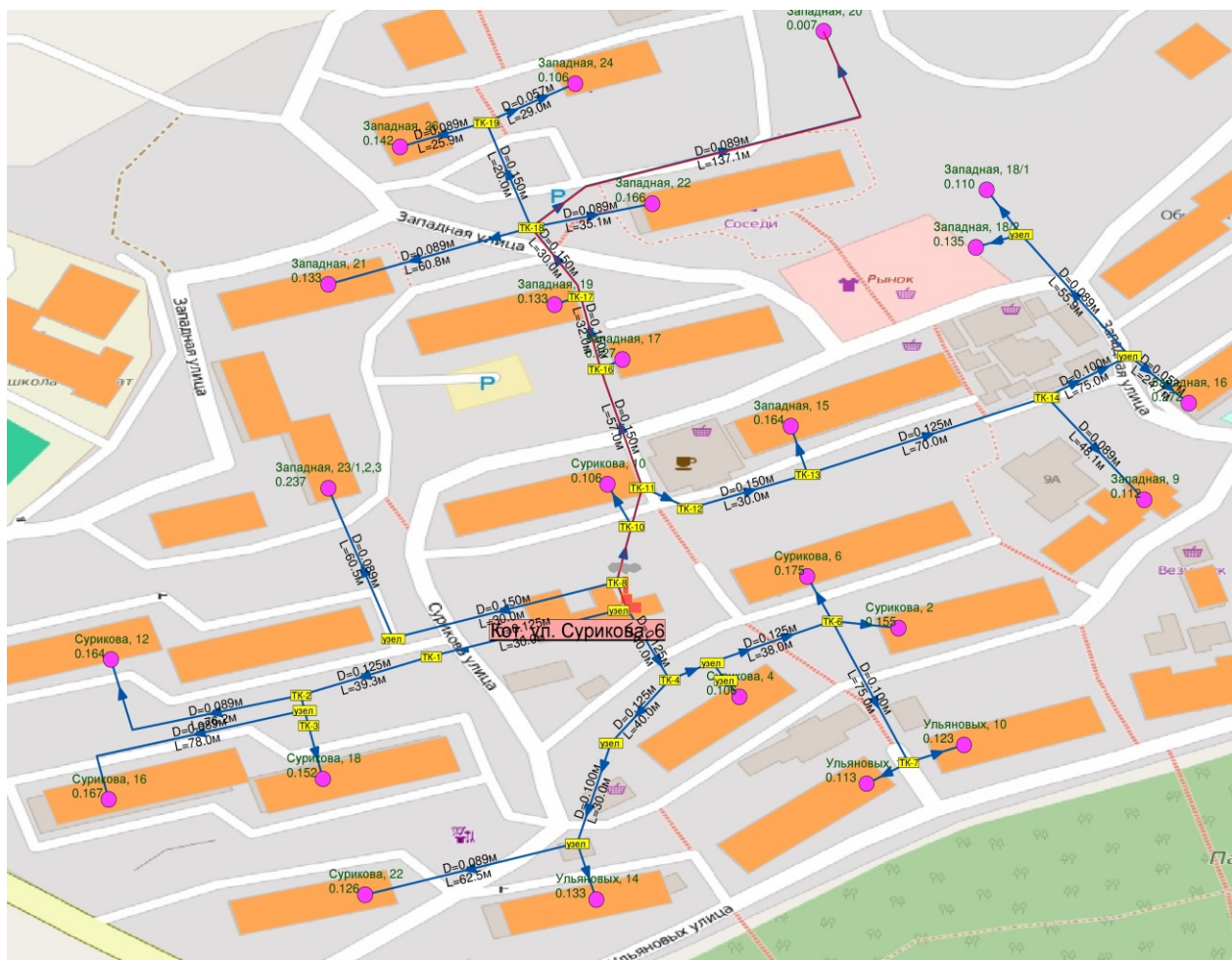
Рисунок – Схема тепловых сетей котельной ул. Сурикова, 6 г. Алупка
