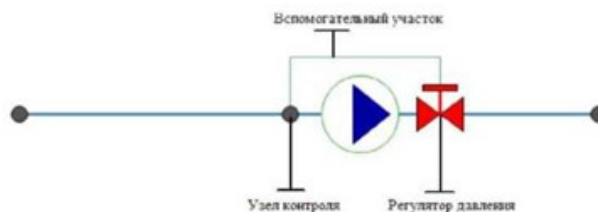
Рисунок 30 - Регулятор давления «до себя» на подающем трубопроводе.
