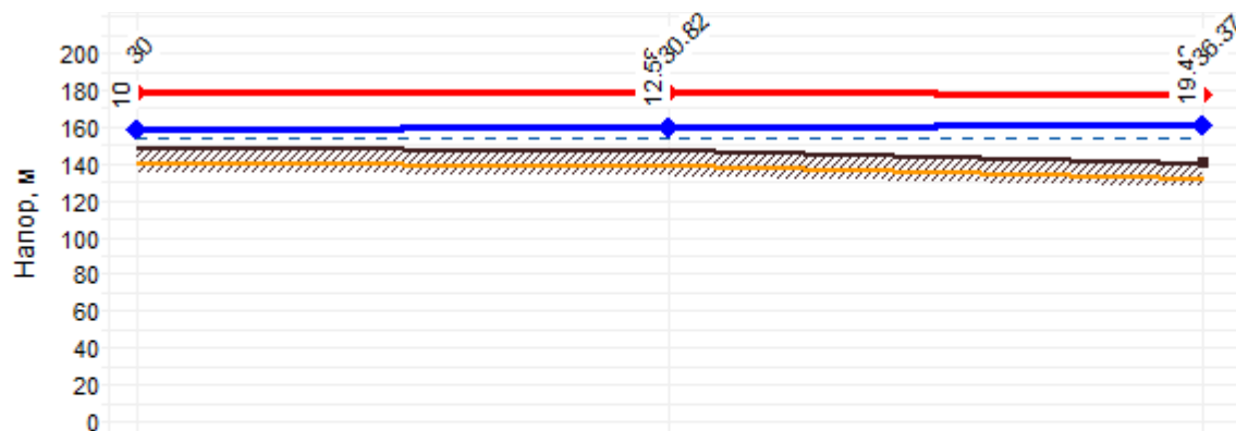
Рисунок – Пьезометрический график от котельной пгт. Симеиз, ул. Ганского, 57а (ГУП РК «Крымтеплокоммунэнерго»)
