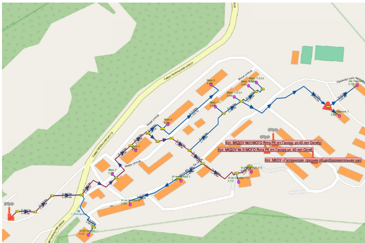
Рисунок – Схема тепловых сетей котельной Севастопольское шоссе, 1 пгт. Гаспра
